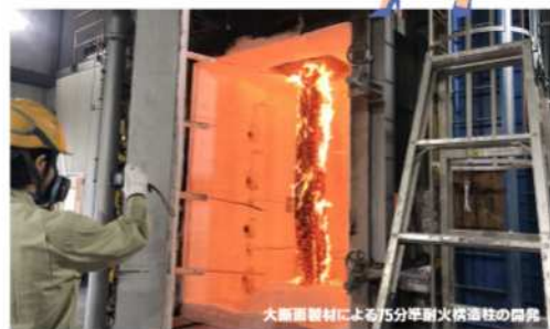
大断面製材による75分耐火構造柱の構築
